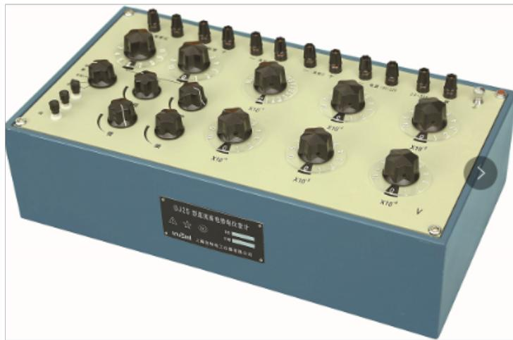
电位差计是利用补偿原理和比较法精确测量直流电位差或电源电动势的常用仪器，它准确度高、使用方便，测量结果稳定可靠，因此还常被用来精确地间接测量电流、电阻和校正各种精密电表。电位差计是一种教学型板式电位差计，通过它的解剖式结构，可以更好地学习和掌握电位差计的基本工作原理和操作方法，培养连接电路和排除简单故障的能力，有利于进一步使用箱式电位差计。用伏特表测量电位差或电源电动势时，由于伏特表必然要从待测电路或电源中分取电流，因此测得的只能是包含伏特表在内的该并联电路此时的端电压，其值小于实际的电位差或电源电动势。天津低电势电位差计测试夹电位差计的基本结构及应用。
